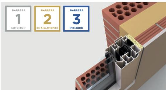
Triple barrera cumple con el principio de estanqueidad y aislamiento de las juntas en los 3 niveles de sellado e aislamiento, donde el nivel interior debe de evitar las condensaciones y las pérdidas de temperatura, el nivel central garantizar la protección térmica y acústica y el nivel exterior proporcionar protección frente al viento y al agua de lluvia.
